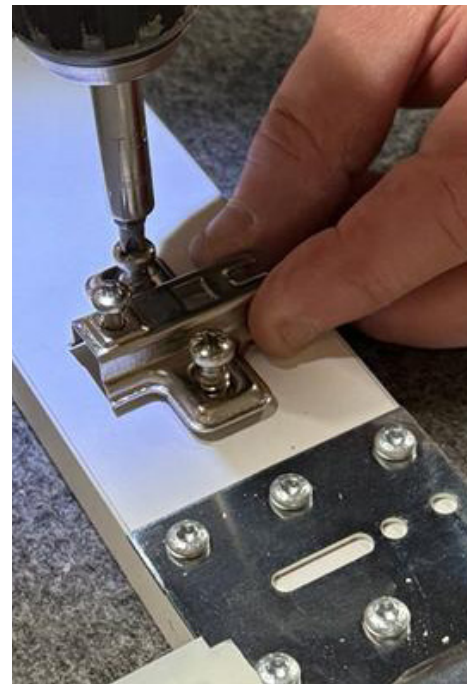
8. Asenna saranan aluslevy paikalleen. Varmista aluslevyn suunta kuvasta.
